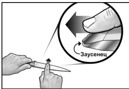
Рисунок 5. Образование заусенцев вдоль кромки лезвия с последующей доводкой лезвия в Этапе 2. Заусенцы необходимо определять, проведя пальцем поперек кромки. Осторожно! Читайте текст инструкции.
