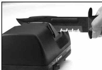
Рисунок 9. Заточка зубчатых лезвий в Этапе 2. Показано лезвие с заусеницами с левой стороны лезвия. (Смотрите инструкцию).
