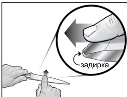
Малюнок 6. Утворіть задирок уздовж кромки леза перед тим, як приступати до Етапу 3.
