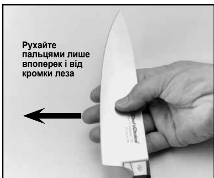
Малюнок 7. Задирок можна помітити, рухаючи пальцями впоперек і від кромки леза. УВАЖНО! Див. текст
