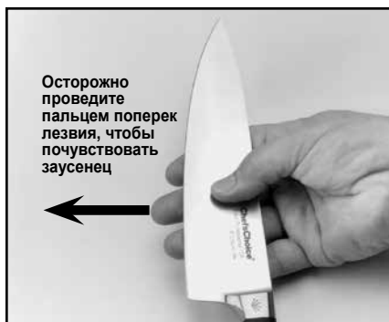
Рисунок 7. Заусенец можно ощутить, если провести пальцами поперек лезвия. Осторожно! Смотрите текст.
